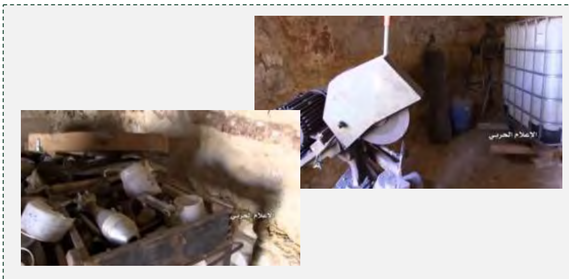
Armes et matériel trouvés dans l'atelier. Droite : Meule d'établi et bouteille d'oxygène (pour la soudure) utilisés dans la fabrication d'obus de mortier et de roquettes. Gauche : Obus fabriqués dans l'atelier (Porte-parole militaire du Hezbollah, 28 juillet 2017)
