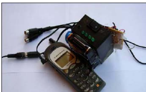
מערכת הפעלה אלחוטית המבוססת על מכשיר טלפון סלולרי להפעלה של עד ארבעה מטענים בדירוג
