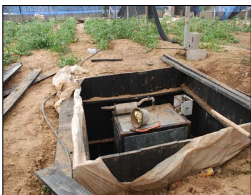
גנראטור וכלי החפירה, שהתגלו בסמוך לפיר של מנהרה. הטמנת הגנראטור באדמה נועדה להשתיק את הרעש שלו ולהקשות על גילויו (16 באוגוסט 2007, אתר דובר צה"ל)
