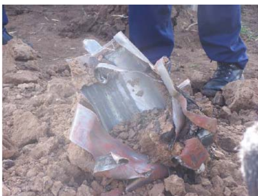
Ogive d'une roquette au point d'impact
