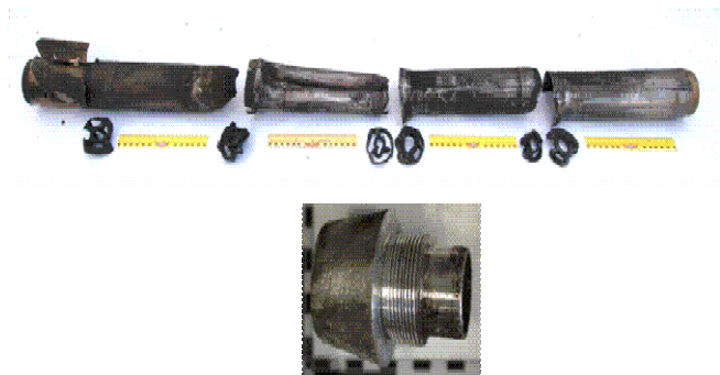
Roquette modulaire de 122 mm rocket dont le moteur a été démonté en quatre éléments pour faciliter son transport clandestin. Portée maximale : 20 km
