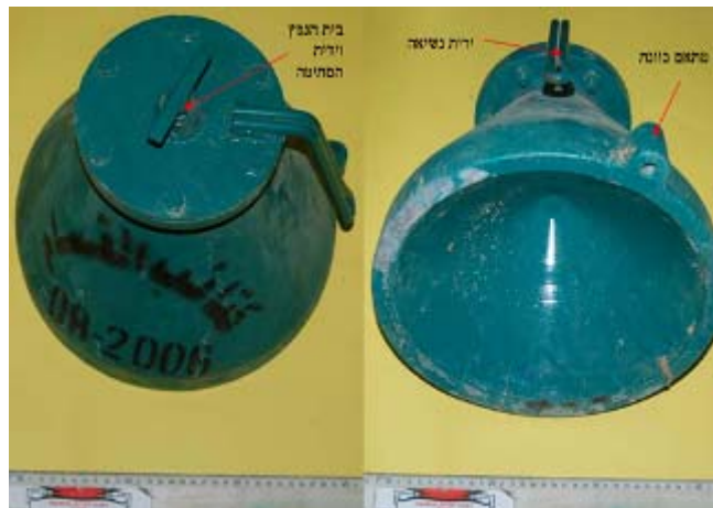
IED artisanal Shawaz (flamme en arabe) fabriqué par le Hamas. La capacité de pénétration de ces IED est supérieure (pouvant transpercer 200 mm d'acier) à celle des engins explosifs couramment utilisés par les organisations terroristes palestiniennes
